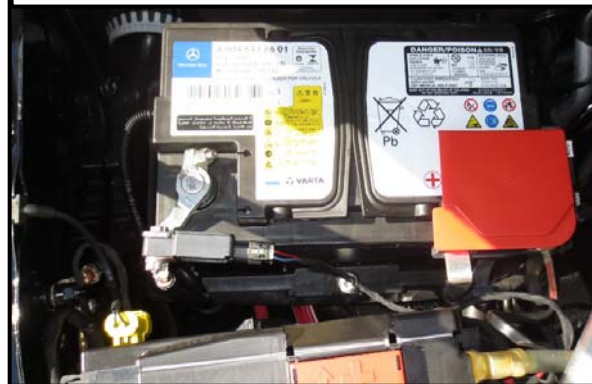
Reinluftfilter und Fahrzeugbatterie demontieren
