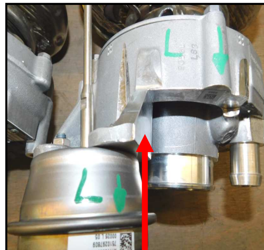
Die gefräste Fläche ist Merkmal des in Fahrtrichtung linken Turboladers
